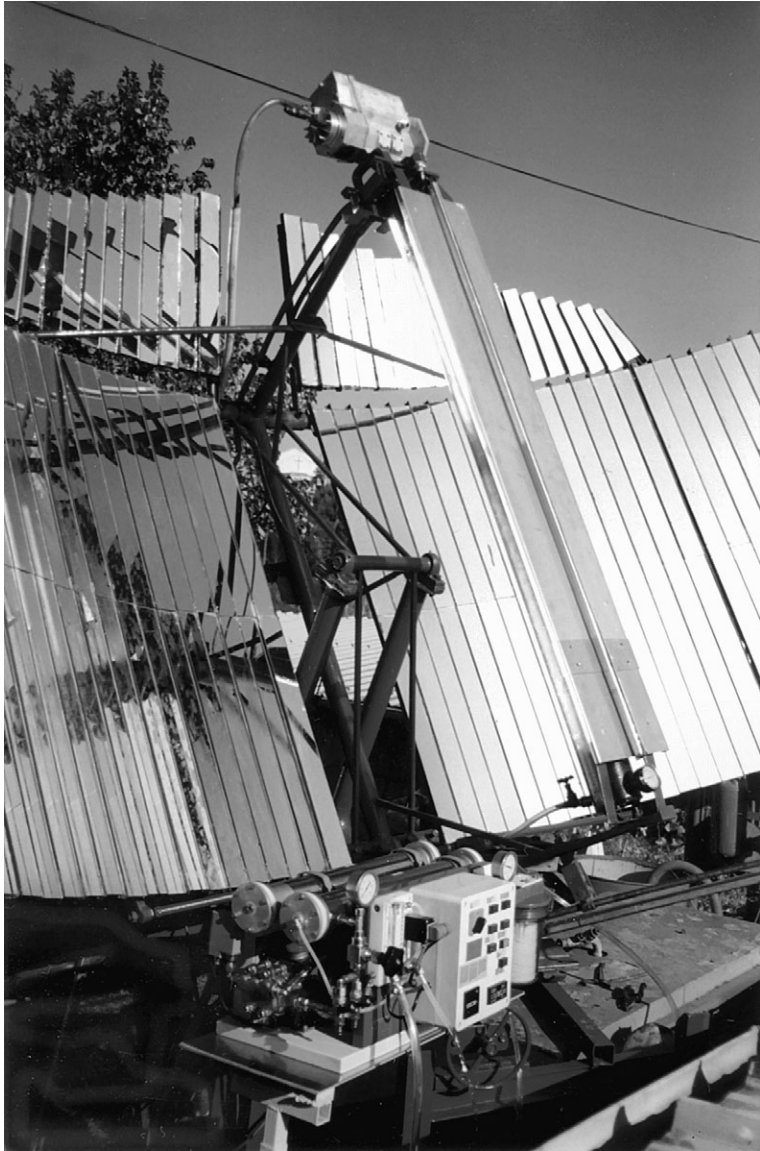
Fig. 3.40. Concentrador solar con motor termodinámico, capaz de producir una potencia eléctrica neta de 1380 W utilizando una superficie especular de 6 m 2 .
