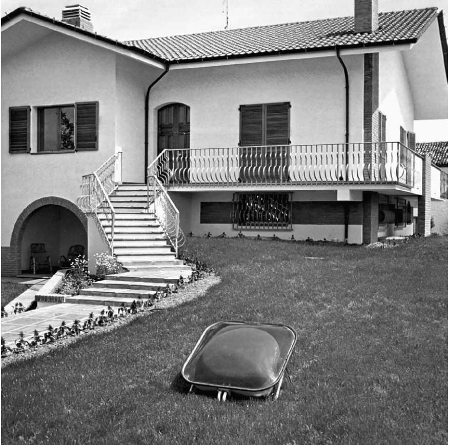
Fig. 3.42. Pequeño captador-acumulador solar de 135 litros de capacidad, ideal para terrazas o jardines.
